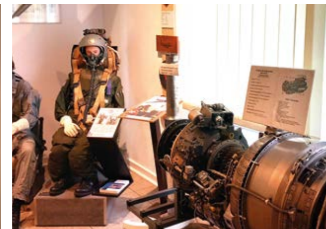
Ein interessantes Exponat, das Triebwerk der Bell UH-1D vom Typ Lycoming T-53-L13 als Anschauungs-Schnittmodell in der Ausstellung.
