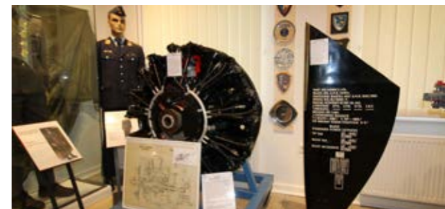
Ein Blick in die Geschichte der Rettungsfliegerei: Zu sehen sind der 9-Zylinder-Sternmotor vom Typ Alvis Leonides als Schnittmodell sowie das Innenleben eines Holzrotorblattes der „Sycamore“.
